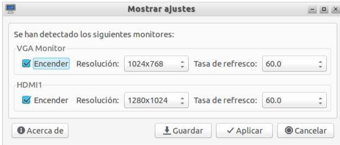
La conexión relativa al proyector es la indicada mediante el rotulo **VGA Monitor**, mientras que la otra se refiere al monitor conectado al computador.
